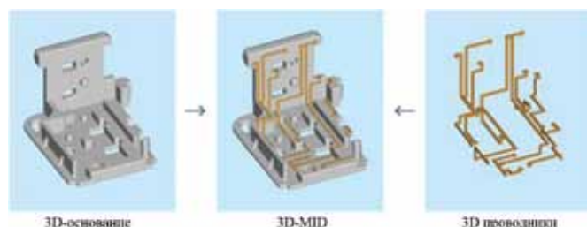
Рис. 1 Схематичное изображение 3D литого монтажного основания. Источник: 3-D MID e.V.
