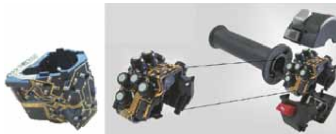
Рис. 6 Переключатель, выполненный по технологии 3D-MID, в мотоцикле BMW K46 Superbike. Источник: Kromberg & Schubert GmbH & Co. KG, SelectConnect Technologies
