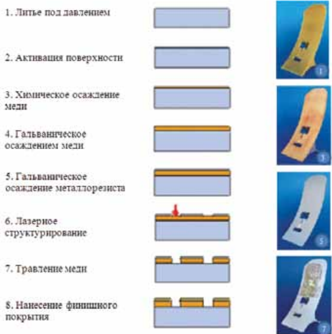
Рис. 11. Схема процесса субтрактивного лазерного структурирования. Источник: 3-D MID e.V.
