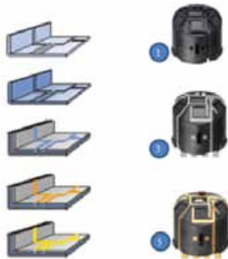
Рис. 14 Схема процесса изготовления 3D-MID с применением двухкомпонентного литья. Источник: 3-D MID e.V.
