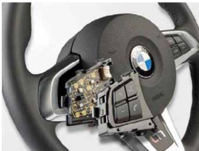
Рис. 5 Руль BMW Z4 со встроенным 3D-MID. Источник: SelectConnect Technologies
