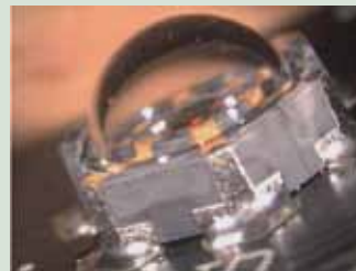
б) мощный светодиод, смонтированный на плату
