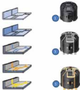
Рис. 14 Схема процесса изготовления 3D-MID с применением двухкомпонентного литья. Источник: 3-D MID e.V.
