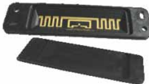
Рис. 9 3D-MID радиометка. Источник: 3-D MID e.V.
