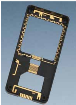
Рис. 4 3D-MID антенна для мобильных телефонов следующего поколения, объединяющая на одном основании антенну для работы в 4G-сетях, антенну для приема сигналов GPS, а также антенны для Bluetooth и Wi-Fi. Источник: SelectConnect Technologies
