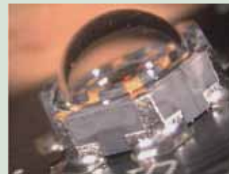
б) мощный светодиод, смонтированный на плату
