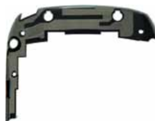
в) Лазерная гравировка рисунка антенн на поверхности основания
